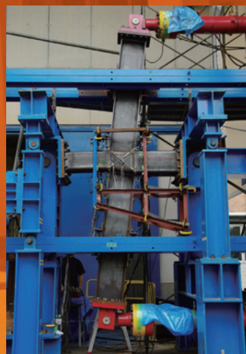
鋼構造骨組の大実大載荷実験
