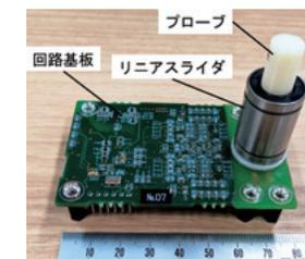
図1：磁気式食感センサ
