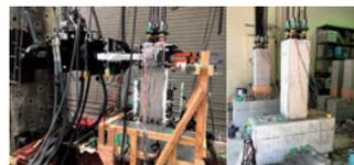
図2: 水平力載荷実験の装置と PCaPC 橋脚試験体
