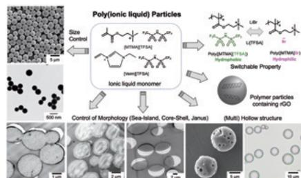
図1：ポリイオン液体粒子の構造制御
