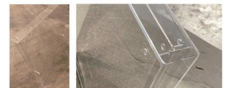
図1：MPPを利用した吸音性パーティション
