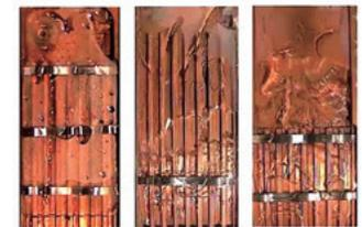
図2：平板型サーモサイフン内流動挙動
