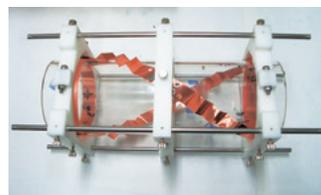
図2：試作可変ピッチヘリカルアンテナ
