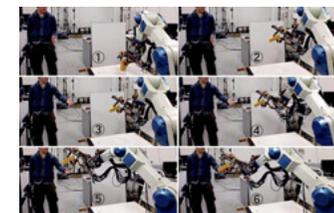
図2：ロボットから人への手渡し
