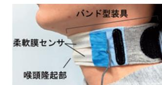
図2：柔軟膜ひずみセンサを組み込んだ嚥下計測用装具
