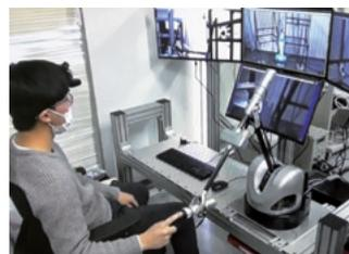
図2: 複数画面を有する遠隔操縦システムのコックピット
