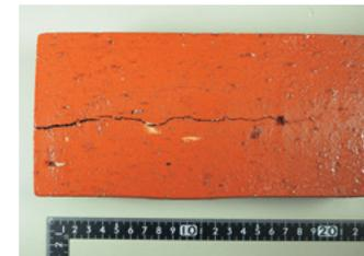
図1: 凍結融解作用によりひび割れが生じたレンガ
