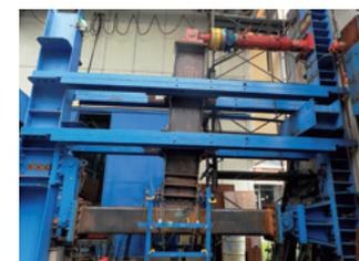
図1：梁端接合部の載荷実験
