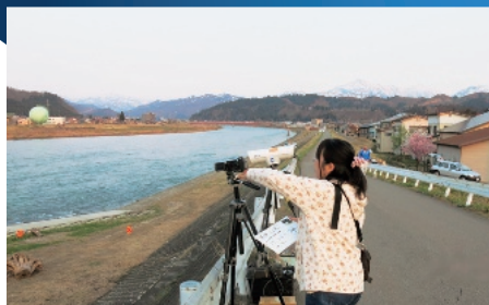
魚野川流量観測の様子
