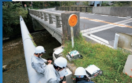
PC橋の補修後モニタリング
