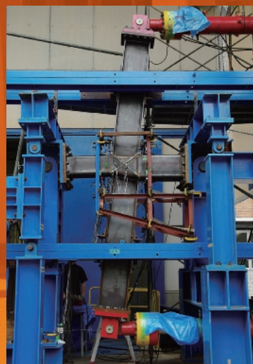
鋼構造骨組の実大載荷実験
