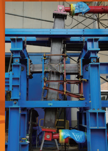
鋼構造骨組の突大載荷実験
