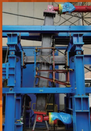
鋼構造骨組の突大載荷実験
