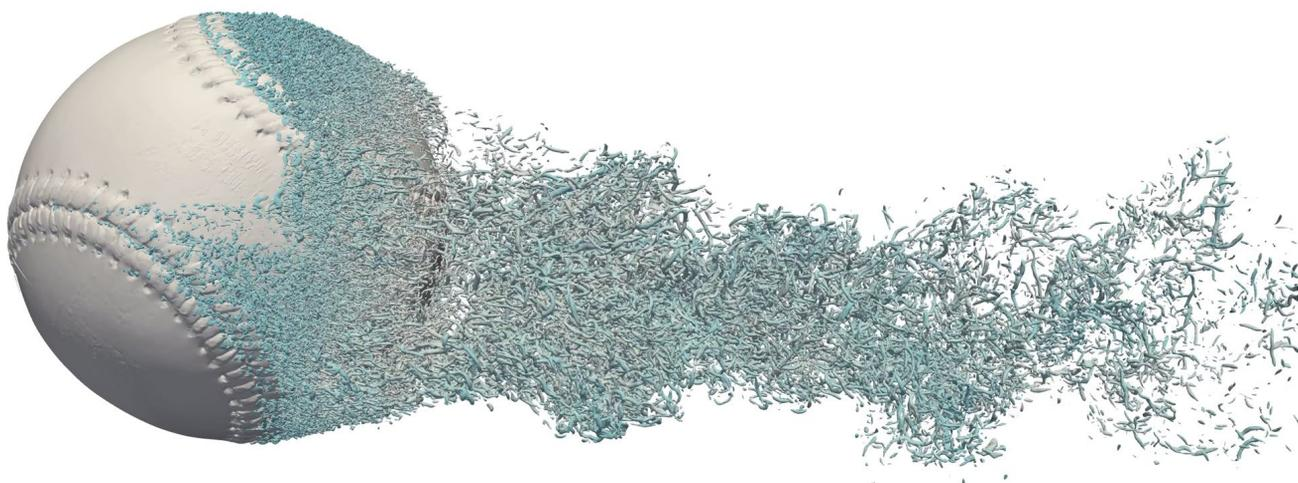
MLBで活躍している大谷翔平選手の投球をスパコンを用いた大規模流体シミュレーションにより解析する。高さ 0.9 mm の野球ボールの縫い目の影響が非常に重要であり、最も細かい格子は 50  $\mu\text{m}$  以下となる。あまり落ちずに横に大きく曲がるスーパースピット（フォークボール）の謎を解き明かし、ボールにかかる空力を積分することでボール軌道を再現する。混相流シミュレーションや流体構造連成シミュレーションについても紹介する。
