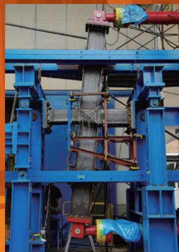
鋼構造骨組の実大載荷実験
