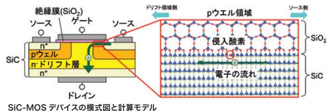
我々の教育研究分野では、物質やデバイス中の電子の振る舞いを、量子力学に基づいて、大規模なモデルで高精度に計算できる計算理論と、この理論に基づくソフトウエアの開発を行っています。図は、次世代パワーデバイスとして期待されている SiC-MOS 界面の原子構造と抵抗の関係を調べたものです。このように、最先端のスパコンを用いて物理現象の解明と予測を行い、高性能デバイスや新しい機能を持ったデバイスの開発に挑戦しています。
