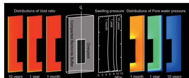
地下水の浸潤によるベントナイトバリアの変状予測シミュレーション
