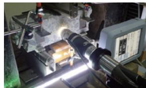
マイクロスコープを用いたコンクリートのひび割れ観察と画像解析結果
