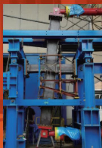
鋼構造骨組の実大載荷実験
