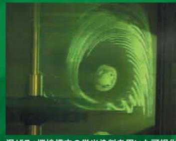
混ぜる: 搅拌槽内の蛍光染料を用いた可視化
