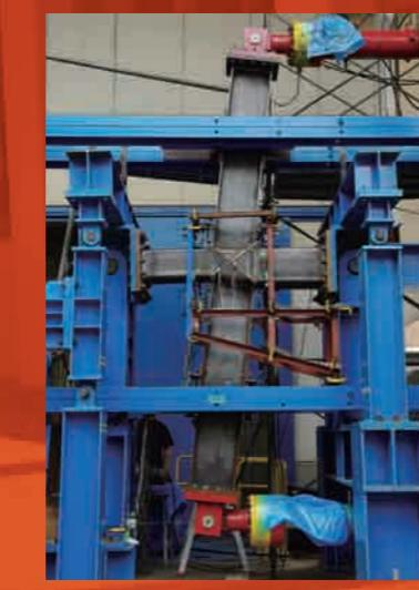
鋼構造骨組の実大載荷実験
