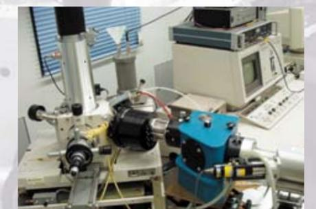
電子ビーム変調反射分光装置による新しい半導体材料の開発
