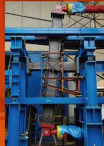
鋼構造骨組の実大載荷実験
