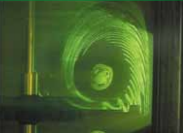
混ぜる：攪拌槽内の蛍光染料を用いた可視化
