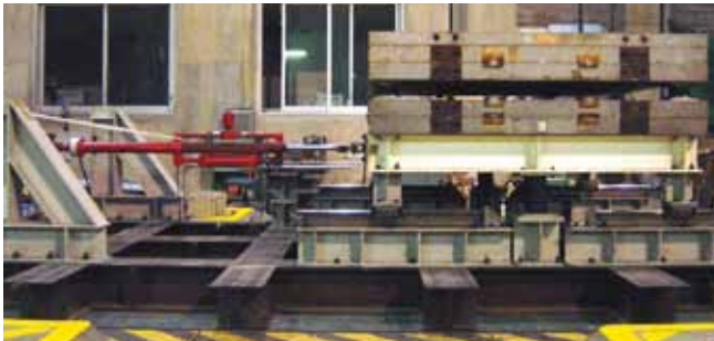
MRダンパーによる免震構造制御の振動台実験
