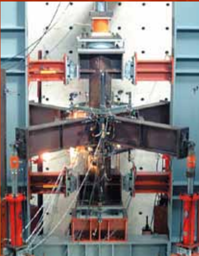
立体鋼構造骨組の実大載荷実験
