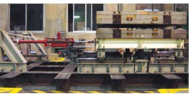
MRダンパーによる免震構造制御の振動台実験
