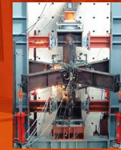
立体鋼構造骨組の実大載荷実験
