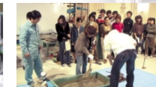
構造材料実験・コンクリート練り（建設構造実験室）
