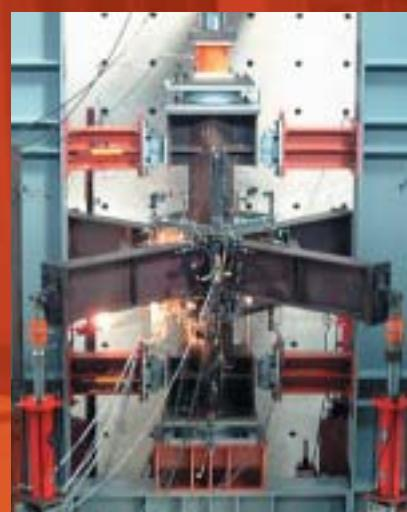
立体鋼構造骨組の実大載荷実験
