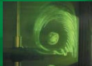
混ぜる：攪拌槽内の蛍光染料を用いた可視化
