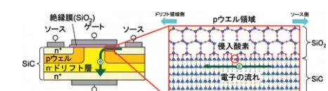
図2：SiC デバイスの模式図と計算モデル
