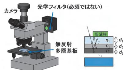
図1：左：観察の模式図。右：無反射多層基板の模式図。
