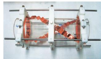
図2：試作可変ピッチヘリカルアンテナ
