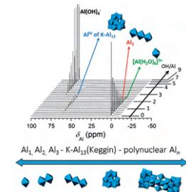
図1: 定量<sup>27</sup>Al NMR法で分析できるAl多核錯体
