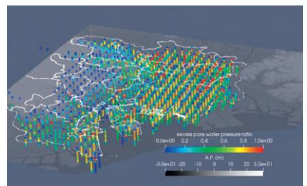
図1：過剰隙間水圧比の最大値分布
