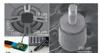
図2：極小3軸力覚センサデバイスの開発例
