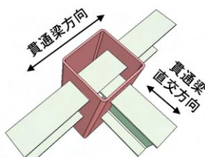
図1：梁貫通形式CFT柱梁接合部
