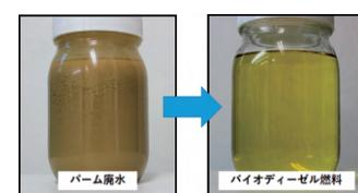
図2：パーム廃水から変換されたバイオディーゼル燃料
