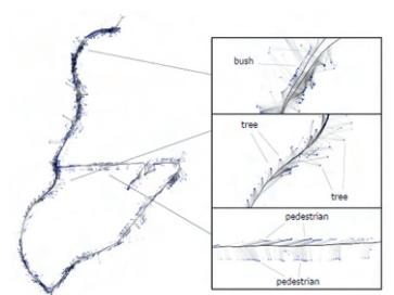
図2：移動ロボットの走行データから構築された地図の例
