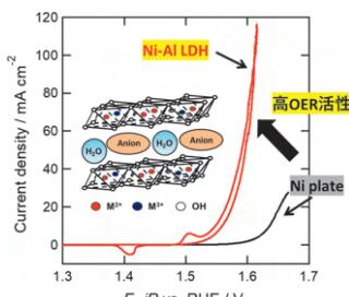
図1：合成したNi合金系無機材料の酸素発生特性
