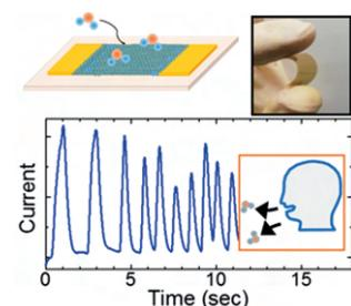
図2：シリコン量子ドット呼気センサー
