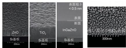
図1：酸化物薄膜と金ナノ構造の電子顕微鏡写真
