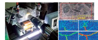
図1：マイクロスコープを用いた微細ひび割れの進展計測
