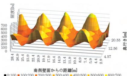
図2：ドローンにより測定された高所（5m）の照度分布
