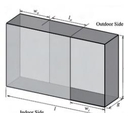
図2: プレナム構造を採用した換気機能を有する窓・ドア
