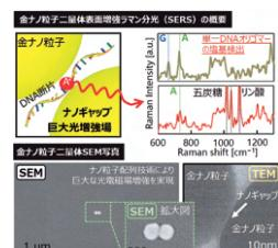
図1：表面増強ラマン分光1分子計測技術の概要
