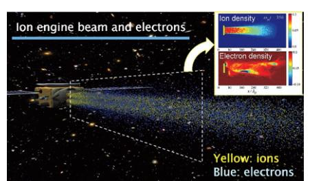
図2：推進器放出のイオンビームと電荷中和用電子
