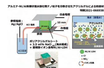
図1：イオン交換性層状複水酸化物ナノ粒子を含む防錆剤
