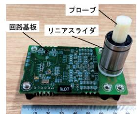
図1：磁気式食感センサ
