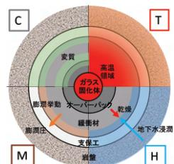
図1：施設施工後に想定される緩衝材の状態例
