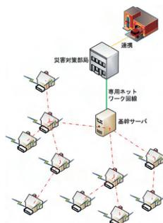
図1：被災情報収集システム
