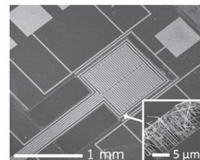
図1：シリコンナノワイヤの熱電特性の評価デバイス
