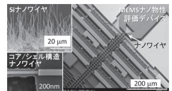
図1：気相成長Siナノワイヤとナノ物性評価デバイス
