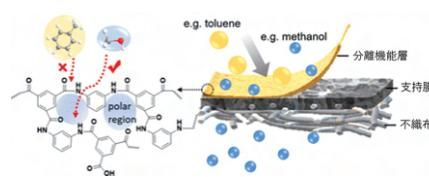
図2：分子設計した分離機能層を有する有機溶媒分離膜
