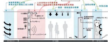
図2：地下公共通路での人流・気流センシングと空調制御
