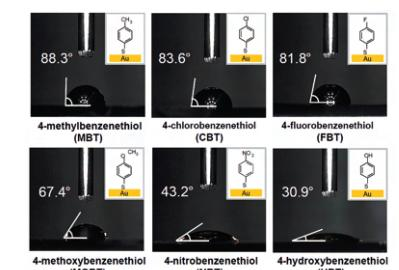
図2：単分子修飾した金表面の水接触角
