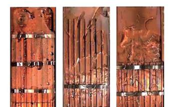
図2：平板型サーモサイフォン内流動挙動
