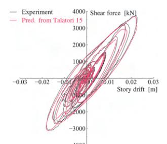
図2：地震応答予測の例
