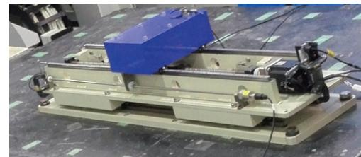
図1：振動台実験用のアクティブマスダンパー
