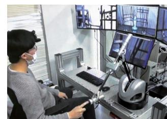
図2：複数画面を有する遠隔操縦システムのコクピット
