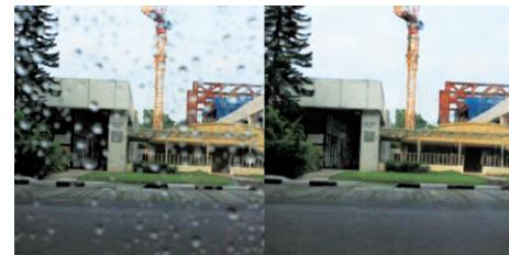
図1：画像処理によるガラス面の水滴の除去
