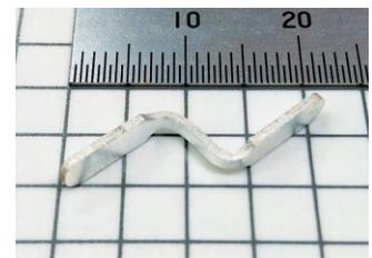
図1：曲げて戻しても壊れないマグネシウムの変形例
