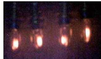
図1：傾斜カスプ磁場の荷電分離で点灯したランプ
