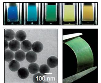
図1：結晶シリコンナノ粒子インクの写真と電子顕微鏡像
