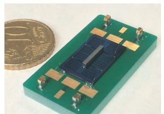
図1：MEMS環境振動発電素子（エネルギーハーベスタ）
