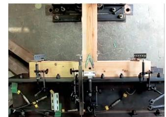
図2：柱-土台接合部試験体
