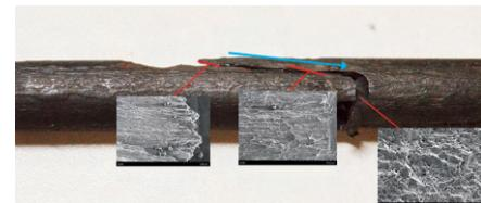
図1：SEMによるフラクトグラフィー破面解析
