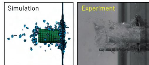
図2：板ガラスの衝突破壊シミュレーション
