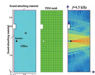
図2：オフィス内の音圧レベル分布(4.5kHz)
