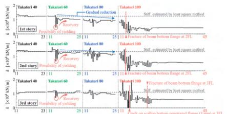
図1：剛性の時刻歴および損傷状態との対応
