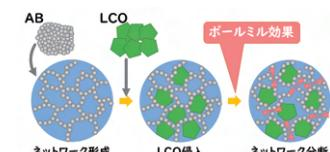
図1：正極スラリー作製時の内部構造変化
