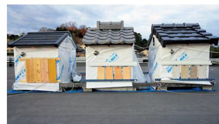
図2：表面処理の効果と問題点を検証するための曝露試験
