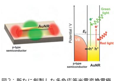
図2：新たに創製した多色応答光電変換電極
