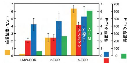
図1：各種接着剤を用いたPPの接着強度と界面厚み
