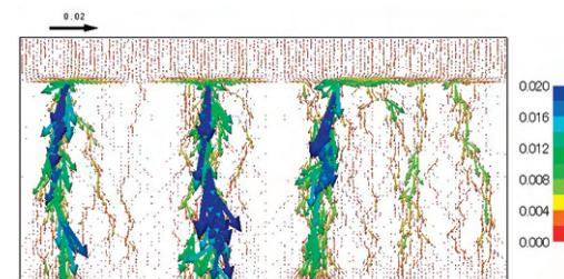
図2：フィンガーフロー発生時の流速ベクトル分布
