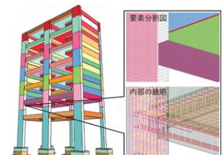
図1：鉄筋コンクリート建物の詳細解析モデル
