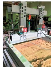
図1：埋設管に作用する地盤拘束力実験
