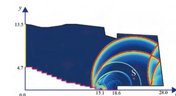
図1：ホール内の音響伝搬の可視化
