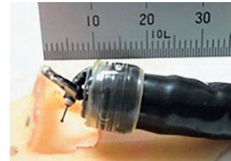
図1：胃カメラに通した極細径の鉗子
