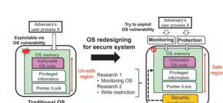
図1：OSにおける高度セキュリティ機構の概要
