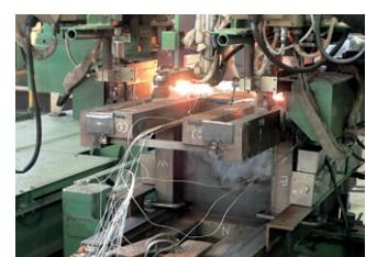
図2：超高強度箱形断面部材の角溶接の施工試験
