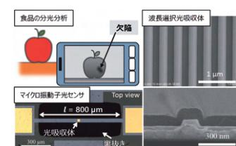
図2：MEMS振動子・波長選択光吸収体集積センサ
