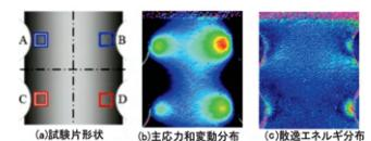
図1：試験片形状、応力分布および散逸エネルギー分布
