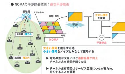
図1：最適送信パケットペアリングによる高効率無線伝送
