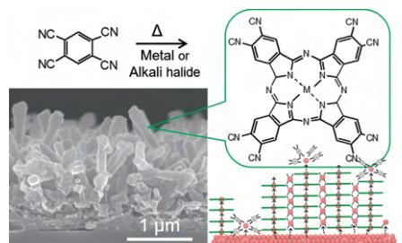
図1：MPc ロッドの断面SEM像とロッド成長モデル
