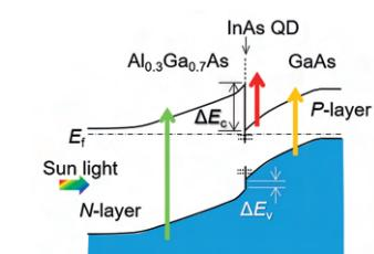
図1：アップコンバージョン太陽電池のバンド構造
