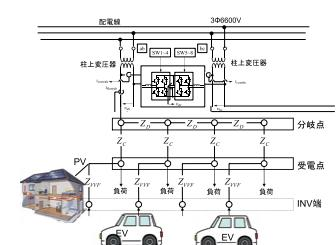
図2：電力潮流制御コンバータの構成例
