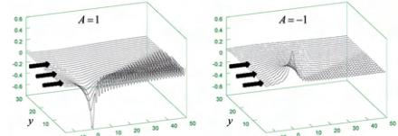
図1：圧力分布背後にできる波（左：振幅正、右：負）
