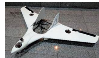
図1：開発したティルトロータタイプの VTOL ドローン
