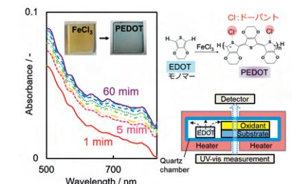
図2：PEDOT 気相重合中の吸収スペクトル変化
