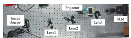
図2：光学的勾配降下演算システムの光学系
