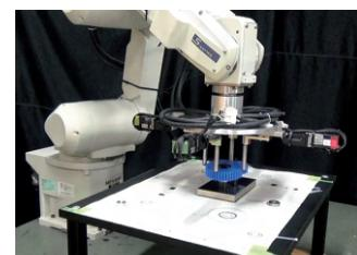
図1：ギヤユニットを治具なしで組立て可能なロボット
