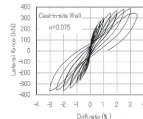
図2：ドリフト硬化型RC耐震壁の履歴性状
