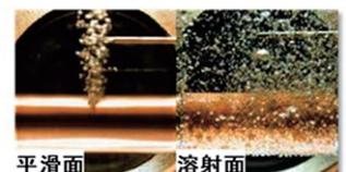
図1：同じ熱流束での溶射被膜によるプール沸騰伝熱促進
