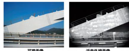
図1：近赤外線計測による橋梁構造部材の塗膜劣化評価
