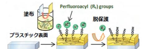
図1：高分子塗布によるプラスチック表面の機能化
