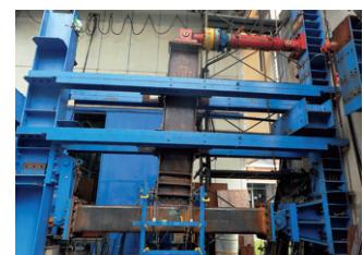
図1：梁端接合部の載荷実験
