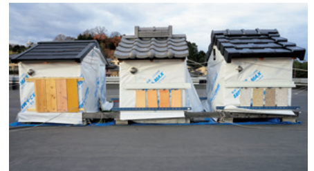
図2：表面処理の効果と問題点を検証するための曝露試験
