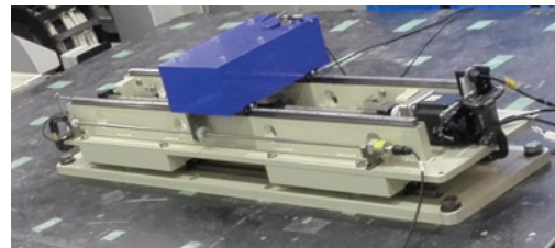
図1：振動台実験用のアクティブマスダンパー
