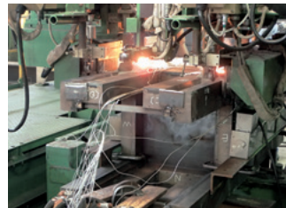
図2：超高強度箱形断面部材の角溶接の施工試験
