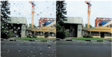
図1：画像処理によるガラス面の水滴の除去
