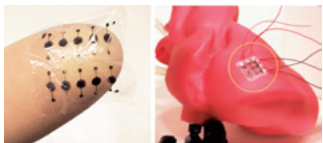
図1：有機強誘電体のアレイ構造とセンサ機能
