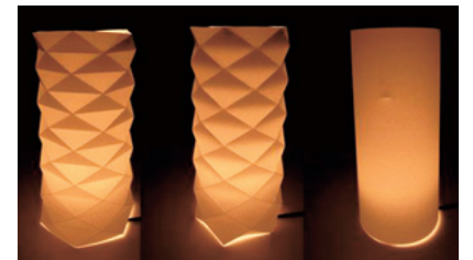
図1：吉村パターン、変形吉村パターン、円柱による行灯の輝度分布
