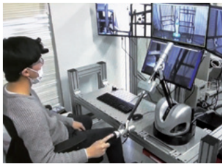
図2：複数画面を有する遠隔操縦システムのコクピット
