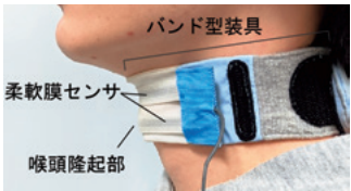
図2：柔軟膜ひずみセンサを組み込んだ嚥下計測用装具
