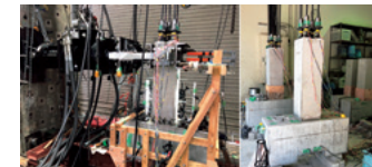
図2：水平力載荷実験の装置とPCaPC橋脚試験体
