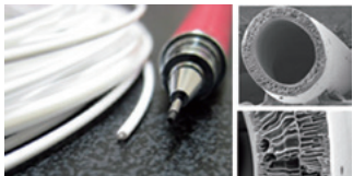
図1：作製した中空糸膜
