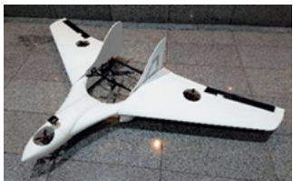
図1：開発したティルトロータタイプのVTOLドローン
