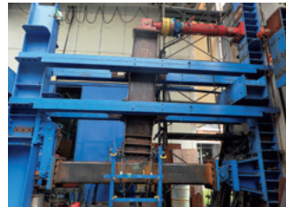
図1：梁端接合部の载荷実験
