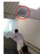
階段の位置を知らせる音案内 一般に天井付近に設置
