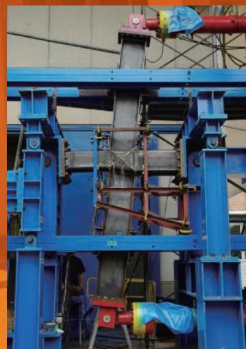
鋼構造骨組の実大載荷実験
