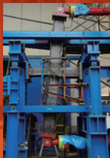
鋼構造骨組の実大載荷実験
