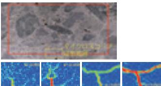
マイクロスコープを用いたコンクリートのひび割れ観察と画像解析結果
